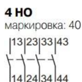
Рис. 4 Принципиальные электрические схемы фронтальных блок-контактов 3RH1921- _F_ для S0...3
