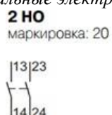
Рис. 3 Принципиальные электрические схемы фронтальных блок-контактов 3RH1911- _F_ для S00
